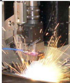
Traitement anti- corrosion de boisseau sphérique par rechargement laser
