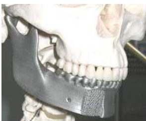
Prothèse maxillaire en titane réalisée par prototypage laser
